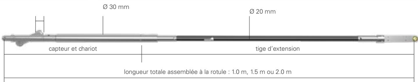
(1) La performance est garantie pour une installation en forage vertical (marge ±2° de la verticale absolue), en tout point du forage (ISO 18674-3).
